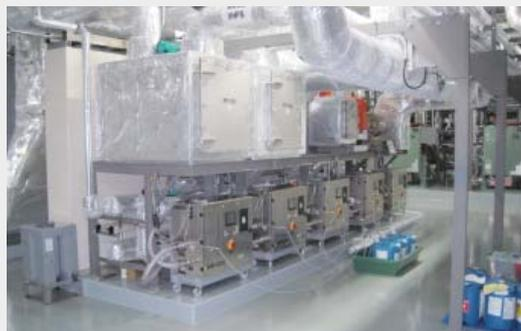
ドライ方式の過酸化水素除染システム
