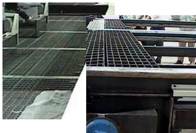
自動収納グレーチング
