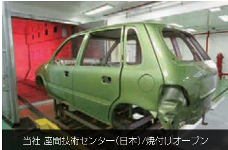
E-DIP 環境に優しい前処理・電着ラインの塗装システム
