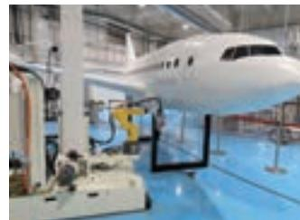
航空機機体整備の自動化を検証するためのシステムを備えています。現在、人の手で行われている整備作業の中で、特に負荷が高いのが機体下面の研磨工程です。研磨作業の自動化により、作業負荷軽減、作業環境の改善や工程時間の短縮を目指します。
