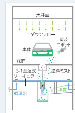
(図1) 湿式スクラパー式塗装ブースのフロー
