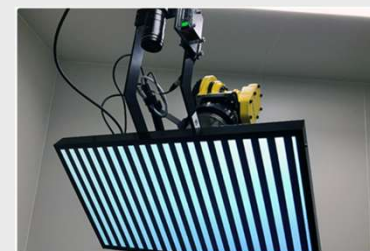
塗装完了後の表面検査装置
