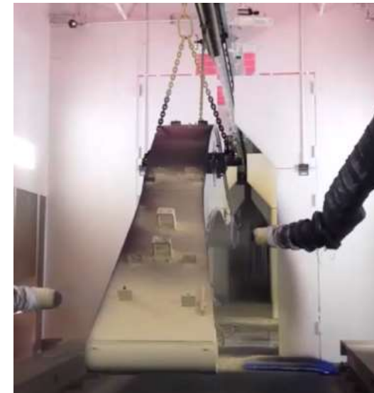
建設機械のフレーム塗装
