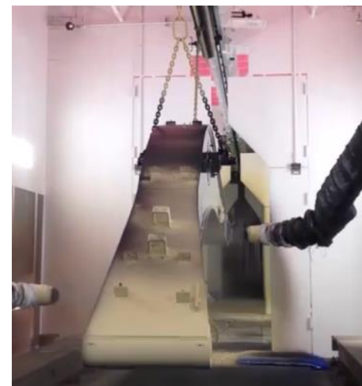
建設機械のフレーム塗装
