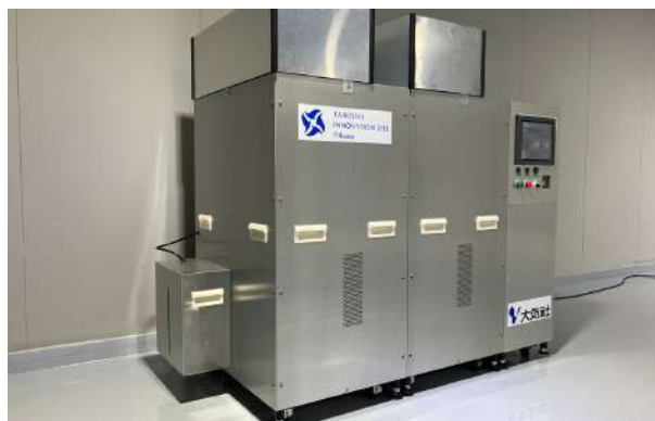
実証実験後、返却されたDAC装置。得られた稼働データの解析が行われている
