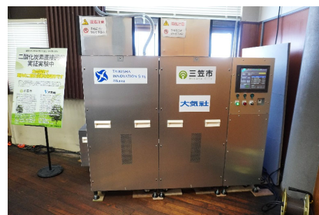
実証実験で使うDACを採用した 二酸化炭素回収装置
